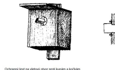
Ochranný kryt na vletový otvor proti kunám a kočkám
